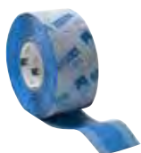
CONTEGA SL Aansluitband met 3 kleefstrips en dampsremmende eigenschappen om kozijnen aan te sluiten op de luchtdichte laag
