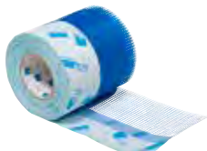
CONTEGA PV Dampremmende pleisteraansluitband met wapening voor luchtdichte en dampremmende aansluiting van ramen op onregelmatige en zelfs licht vochtige muren.
