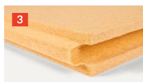
GUTEX Multitherm Panneau isolant en fibres de bois insensible à l'humidité pour façades ventilées, comme isolation sur chevrons supplémentaire ou comme isolation sous chevrons
