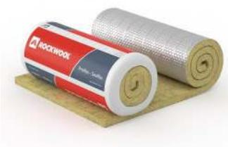
SeaRox WM 620 ALU est un matelas isolant de laine de roche faiblement liée, revêtu d'un treillis métallique galvanisé cousu au moyen d'un fil métallique galvanisé, revêtu sur une face d'un film d'aluminium renforcé.
