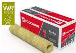
ProRox PS 960 est une coquille isolante concentrique en laine de roche. Ces coquilles sont dotées d'un liant hydrofuge appelé WR-Tech™, permettant d'atténuer le risque de corrosion sous l'isolant (CSI). Le liant WR-Tech garantit le maintien du caractère hydrofuge de la laine de roche, même à des températures de service élevées comprises dans la plage de CSI, tout en préservant ses excellentes performances thermiques. Un revêtement en film d'aluminium renforcé (ALU) est disponible sur demande.
